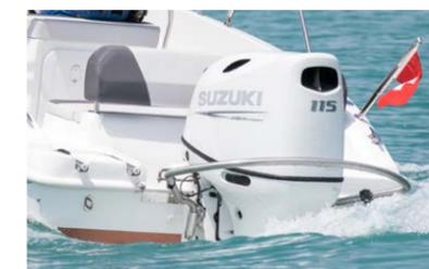
Der neue Suzuki DF115 ist eine geradezu ideale Motorisierung für die Idea 53. Der Einbau mit dem Drive-by-Wire-System ist problemlos und die Kraft der 115 PS verleiht dem Boot nicht gerade Flügel, aber doch eine erstaunliche Sportlichkeit. Die Spitzengeschwindigkeit liegt bei fast 70 km/h, als angenehme Marschfahrt erwiesen sich rund 35 km/h bei gut 3500 U/Min.
