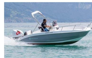
Die Idea 53 ist für ein 5-Meter-Boot erfreulich rassig und trotzdem stabil und sicher unterwegs. Die Rumpfform mit mehreren Knicken und einer ausgeprägten Kimmkante sorgt für viel Stabilität und eine ausgeprägte Spurtreue. Selbst im oberen Geschwindigkeitsbereich mit 50 km/h und mehr fühlt man sich jederzeit sicher. Auch rasche Kursänderungen sind kein Problem.
